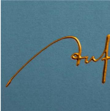
Durch dieses Verfahren, bei dem die Heißfolien- und Reliefprägung, mit ein und demselben Werkzeug kombiniert werden, erhält das Etikett eine herausragende Exaktheit und pure Eleganz.
